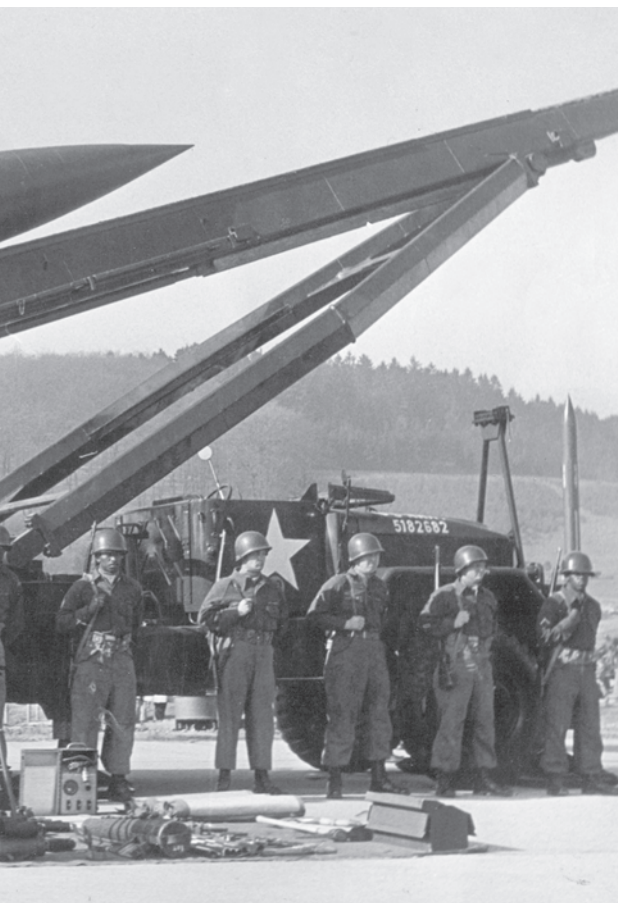
Die un gelenkte nuklearwaffenfähige Kurzstreckenrakete MGR-1 »Honest John« konnte auf dem Gefechtsfeld gegen Ziele in bis zu 25 Kilometer Entfernung eingesetzt werden.
