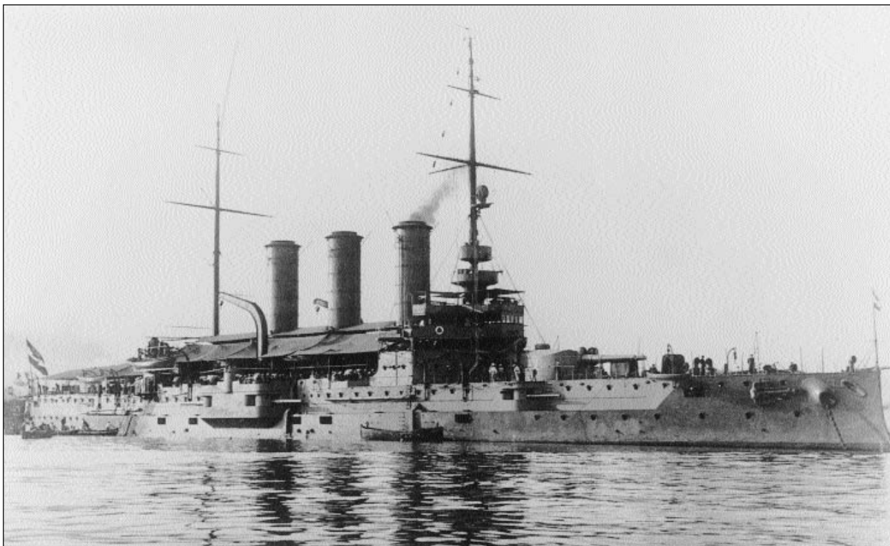
SANKT GEORG voll ausgerüstet. Ein Sonnensegel schützt das Deck vor der Sommersonne. Unter dem 24 cm-Doppelturm ist das 15 cm-Geschütz und in der Schiffsmitte der Kasematt-Erker für die 19 cm-Geschütze zu sehen
